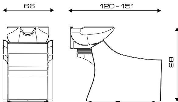
**PIANO DI INSTALLAZIONE \ INSTALLATION PLAN**
