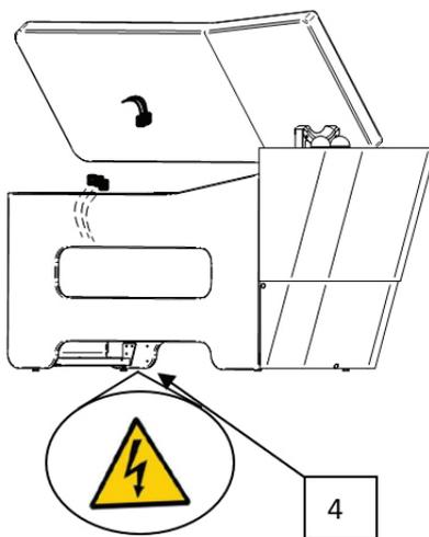
**4)** Provvedere all'**allacciamento idraulico** nella zona posteriore come indicato nella scheda tecnica (1), prevedendo un rubinetto per acqua calda e fredda di chiusura a monte di ogni apparecchio. Gli allacciamenti alla rete fognaria sono effettuati mediante un tubo di scarico  $\varnothing$  40.
