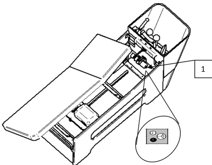
5) Una volta completate le operazioni di allacciamento elettrico ed idraulico, rimontare il materasso del lettino-lavaggio eseguendo nuovamente a ritroso le operazioni del punto 3 ; ruotare il materasso, innestare nuovamente gli spinotti di connessione delle funzioni previste dal lettino, spingere in avanti il materasso innestando l'angolare posteriore alle tre viti sporgenti dal traverso centrale del lettino, avvitarle le viti di serraggio.
