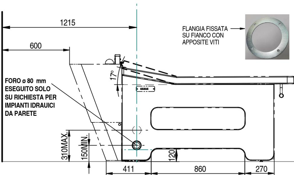
Per l'impianto idraulico è necessario prevedere un rubinetto per acqua calda e fredda di chiusura a monte di ogni apparecchio.
