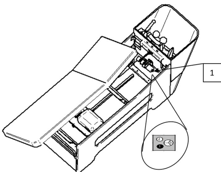
5) Au terme des opérations de raccordement électrique et hydraulique, remonter le matelas de la table de lavage en suivant les opérations indiquées au point 3 en sens inverse ; faire pivoter le matelas, rebrancher les ergots de raccordement des fonctions prévues, pousser le matelas en avant en imbriquant l'angle arrière sur les trois vis sortant de la traverse centrale de la table, puis serrer les vis de serrage.
